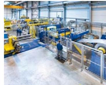
**Abwicklung sowie Schneiden und Spalten von Coils**
